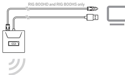
**WICHTIG** Die optische Kabelverbindung ist nur für das RIG 800HD und RIG 800HS.
