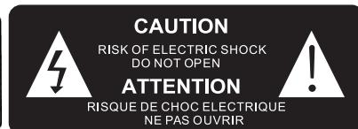
"Het symbool van de bliksem met het pijltje in een gelijkzijdige driehoek is een waarschuwingssteken om de aandacht van de gebruiker te vestigen op de aanwezigheid van elektrische netspanning in het product zelf, die een risico op elektrische schokken zou kunnen veroorzaken."
