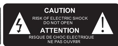
O símbolo do relâmpago dentro de um triângulo equilátero alerta o utilizador da presença no interior do produto de voltagem elétrica perigosa não isolada com potência suficiente para constituir um risco de eletrocussão.
