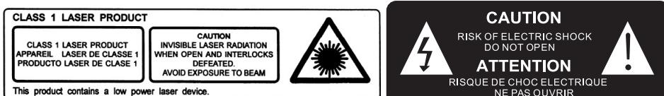
"El símbolo del relámpago con punta de flecha dentro de un triángulo equilátero constituye una advertencia destinada a avisar al usuario de la presencia de tensiones eléctricas dentro del producto, que pueden provocar un riesgo de electrocución."
