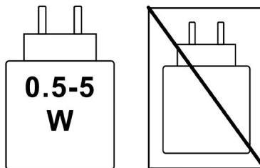
La potencia suministrada por el cargador debe estar comprendida entre un mínimo de 0,5 W (requeridos por el equipo de radio) y un máximo de 5 W para garantizar una velocidad de carga óptima.
