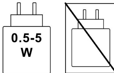
Het vermogen dat door de lader wordt geleverd, moet minimaal tussen 0,5 Watt (vereist door de radioapparatuur) en maximaal 5 Watt liggen om een optimale laadsnelheid te garanderen.
