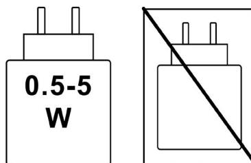
La puissance fournie par le chargeur doit être comprise entre 0,5 W minimum (requis par l'équipement radioélectrique) et 5 W maximum pour garantir une vitesse de charge optimale.
