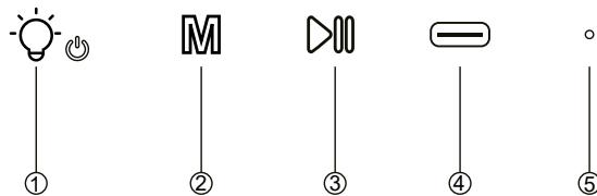
1. : Długie naciśnięcie włącza/wyłącza zasilanie, krótkie naciśnięcie przełącznika tryby oświetlenia
