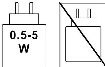
Moc dostarczana przez ładowarkę musi wynosić min. 0,5 W (wymagana przez sprzęt radiowy) i maks. 5 W, aby zapewnić optymalną prędkość ładowania.
