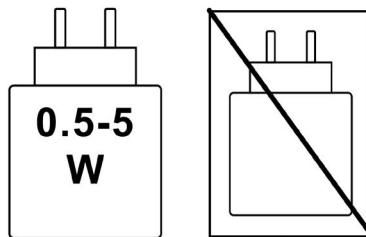
A potência do carregador deve estar entre os 0,5 Watts mínimos (exigidos pelo equipamento de rádio) e os 5 Watts máximos para atingir a velocidade máxima de carregamento.
