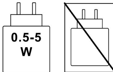
La potenza fornita dal caricabatterie deve essere compresa tra un minimo di 0,5 Watt (richiesti dall'apparecchiatura radio) e un massimo di 5 W per garantire una velocità di ricarica ottimale.
