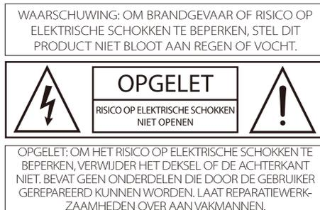
"Het symbool van de bliksem met het pijltje in een gelijkzijdige driehoek is een waarschuwingsteken om de aandacht van de gebruiker te vestigen op de aanwezigheid van elektrische netspanning in het product zelf, die een risico op elektrische schokken zou kunnen veroorzaken."
