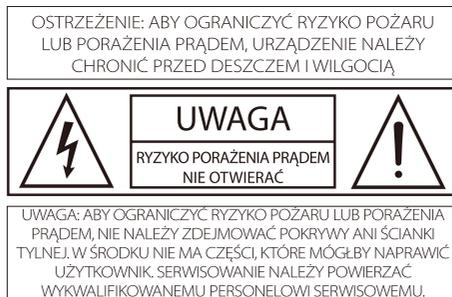
Symbol błyskawicy w trójkącie równobocznym ma na celu ostrzec użytkownika o występowaniu wewnątrz urządzenia niez izolowanego napięcia, dostatecznie wysokiego, aby stwarzać ryzyko porażenia prądem.
