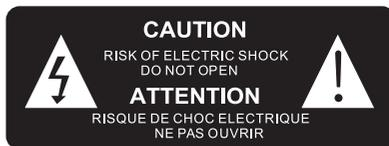
"Le symbole de l'éclair à pointe de flèche inscrit au sein d'un triangle équilatéral constitue une mise en garde destinée à alerter l'utilisateur quant à la présence de tensions électriques secteur à l'intérieur du produit, qui peuvent engendrer un risque d'électrocution."
