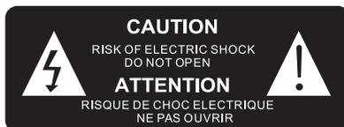
"Il simbolo con il lampo e la freccia all'interno di un triangolo equilatero costituisce un'avvertenza destinata ad avvisare l'utilizzatore della presenza di tensioni elettriche all'interno del prodotto, che possono provocare scosse elettriche."
